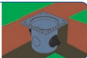
**6** Montar la tubería especificada por el proyecto utilizando la Pasta Lubricante TIGRE.
