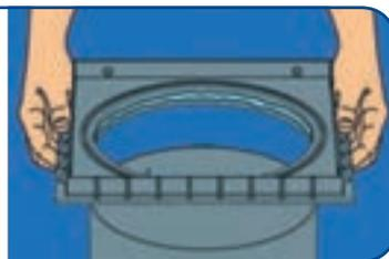
**4** Cortar con un estilete el sello de la entrada del adaptador universal utilizando las marcas existentes según el calibre a utilizar
