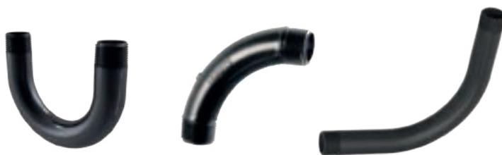
Los conductos y conexiones de esta línea se fabrican con puntas roscadas y, por lo tanto, se indica el uso del Manguito Roscado para conectar un conducto a otro o a las conexiones. No se recomienda hacer bolsas con la ayuda de fuego para unir tuberías y conexiones, ya que, de esta manera, la estanqueidad no está garantizada en las diferentes condiciones que se encuentran en las obras.
