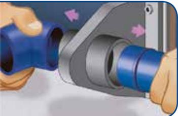
**7** Imediatamente proceda à união. Pare a introdução do tubo na conexão quando os dois anéis visíveis que se formam em função do movimento do material estiverem unidos.
