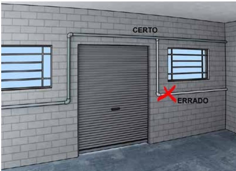
**Passo 1:** Calcular a expansão térmica (e), levando em consideração o comprimento do trecho do tubo, o coeficiente de expansão térmica e a variação de temperatura.
