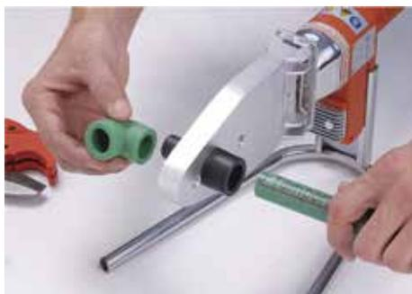
5. Verificar la temperatura de régimen a través del testigo de la termofusora. Al mismo tiempo que se introduce el tubo en la boquilla se deberá introducir también el accesorio, completamente perpendicular a la plancha de la fusora.
