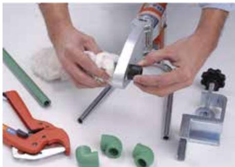
1. Es fundamental antes de comenzar cada fusión verificar la limpieza de las boquillas del termofusor y su correcto ajuste sobre la plancha.
