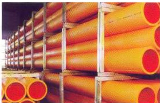
Las tiras pueden ser atadas por marcos de madera, de esta manera se permite el almacenamiento en pilas de tres, madera contra madera, con el peso sostenido por la madera y no por la tubería.
