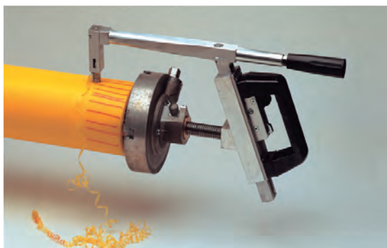
Paso 3: raspar en forma manual o con raspador mecánico 0,3mm de la superficie exterior del tubo aproximadamente. No tocar el tubo con las manos en la zona de raspado.
