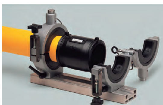
Paso 4: montar el accesorio sobre el tubo hasta el tope.
