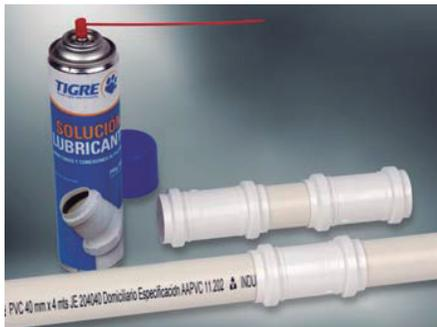
3.-Se desliza las coplas hasta cubrir las uniones entre el tubo nuevo y los extremos del original. Para facilitar el proceso, se debe utilizar lubricante.
