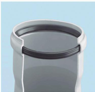
El sello elastomérico del labio simple para drenajes y desagües sanitarios está fabricado de acuerdo a las normas EN 1401-1, DIN 19534, EN 1451-1, DIN 19560. El perfil optimizado del sello con labio simple proporciona una confiabilidad extrema al ser alojado en su cavidad de perfil recto.
