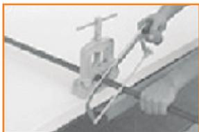
**Paso 2:** Cortar el tubo en la escuadra, remover las rebabas y medir en seguida la longitud máxima de la rosca a ser realizada para evitar abertura en exceso.
