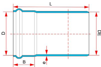
**Consideraciones:** La sigla SN está ligada o representa la resistencia de las tuberías a los esfuerzos externos a los que se ve sometido, es decir, cargas vivas y cargas muertas. Dicha resistencia es función del espesor de pared de la tubería, tipo de zanja, ancho y profundidad, tipos de materiales de relleno y grado de compactación.
