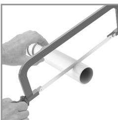
**Paso 4:** Si es necesario, ajuste la longitud del tubo de salida, cortando el excedente.
