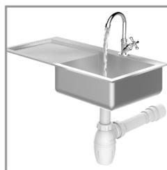
**Paso 6:** Deje correr el agua para llenar el sifón y verificar si existen fugas.
