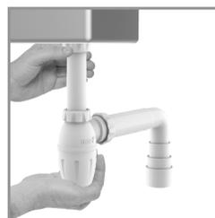
**Paso 2:** Ajuste el tubo de entrada vertical a la posición de la tubería de desagüe y atornille la tuerca del sifón.
