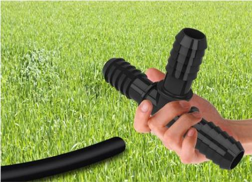
**Paso 2:** Enganche la espiga de la conexión por dentro del tubo con fuerza manual hasta el tope de la conexión.
