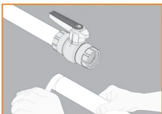
**Paso 1:** aplicar teflón sobre los filetes de la punta del tubo, en favor de la rosca, de tal modo que cada vuelta con traspase a la otra en 1/2 vuelta, en un total de 3 a 4 vueltas variando de acuerdo a la dimensión de la válvula.
