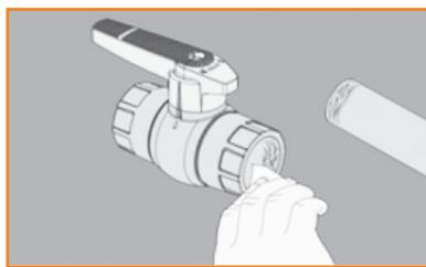
**Paso 2:** limpiar las superficies lijadas con Solución Preparadora TIGRE, eliminando impurezas y grasas. Distribuir uniformemente el adhesivo plástico con pincel o con el propio pomo en las superficies tratadas.
