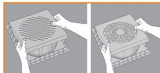
Paso 4: encaje la tapa reforzada (cámara de inspección) o la rejilla de PVC (cámara interconexión) en el porta - tapa de la cámara antes de rellenar alrededor de ésta.
