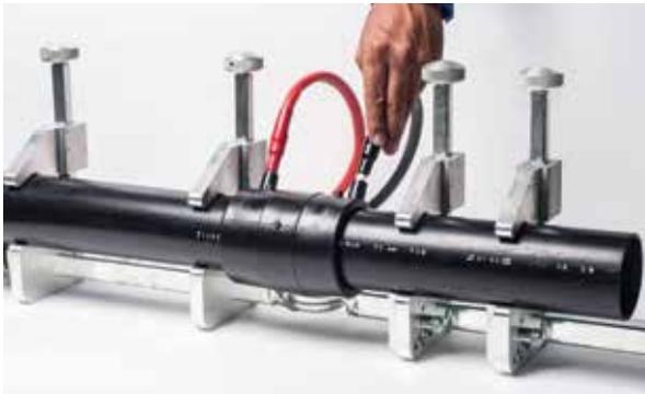
**Paso 5.** Conecte los electrodos de la electrofundidora al accesorio verificando los colores de los terminales, realice la soldadura activando la soldadora. Deje enfriar el tiempo indicado en la etiqueta antes de quitar el alineador.
