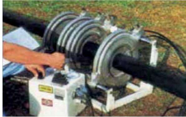
**Paso 1.** A partir de la tabla entregada por el fabricante, verifique la presión de soldadura requerida y súmela a la presión inicial para desplazamiento (inercia de la máquina más el peso propio del tubo a ser desplazado).
