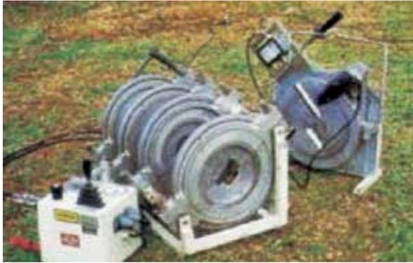
Los equipos comunmente utilizados por termofusión están constituidos por tres elementos: unidad de fuerza (compuesta de una unidad hidráulica y un alineador), refrentador y placa calentadora.
