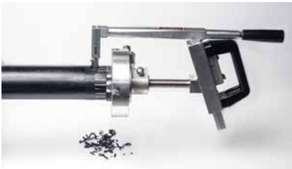
**Paso 3.** Raspe en forma manual o con el raspador mecánico un espesor de aproximadamente 0.3 mm de la superficie exterior. No tocar con las manos la superficie ya raspada.
