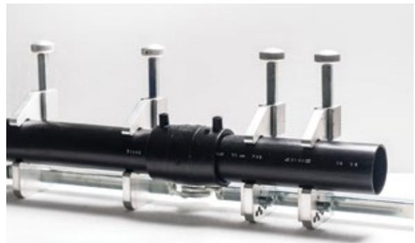
**Paso 4.** Realice los pasos anteriores para el tubo opuesto, retire el accesorio del embalaje e introduzca el tubo hasta las marcas realizadas. La zona que se va a soldar debe permanecer estable e inmóvil, para esto es posible utilizar el alineador.
