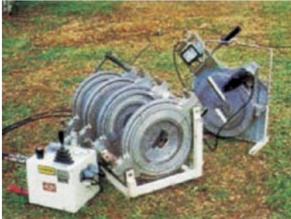
Los equipos comunmente utilizados por termofusión están constituidos por tres elementos: unidad de fuerza (compuesta de una unidad hidráulica y un alineador), refrentador y placa calentadora.
