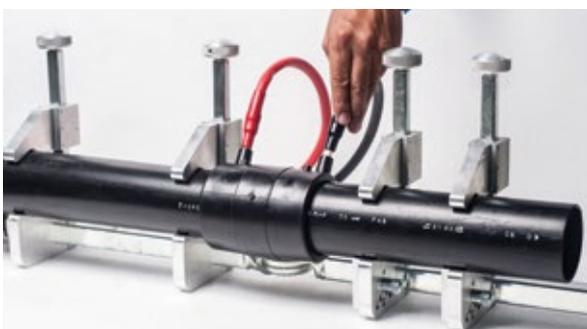
**Paso 5.** Conecte los electrodos de la electrofundidora al accesorio verificando los colores de los terminales, realice la soldadura activando la soldadora. Deje enfriar el tiempo indicado en la etiqueta antes de quitar el alineador.
