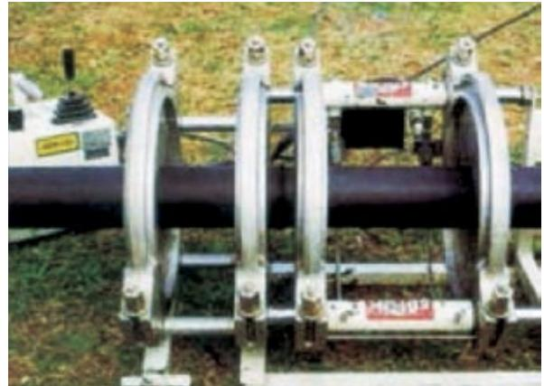
**Paso 7.** Solamente después de logrado el enfriamiento requerido, puede mover el equipo para una próxima soldadura.
