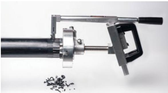
**Paso 3.** Raspe en forma manual o con el raspador mecánico un espesor de aproximadamente 0.3 mm de la superficie exterior. No tocar con las manos la superficie ya raspada.
