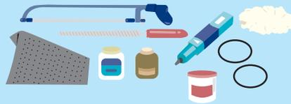
Materiales y herramientas a utilizar: lija Nro. 100, sierra, trapo limpio, Solución Limpiadora, adhesivo Tigre y Pasta Lubricante.
