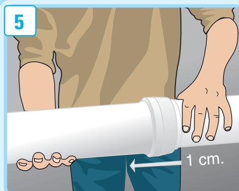
**Previsión de huelgo o espacio para movimientos de la cañería:** Una vez que el extremo introducido hace tope en el fondo del enchufe, debe retirarse 1 cm para que quede un espacio que permita absorber los movimientos que pueda tener el conjunto.
