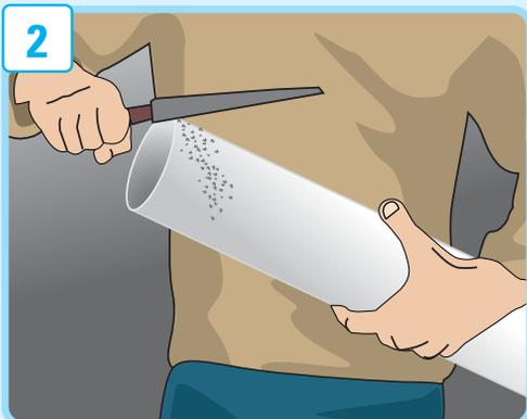
**Corte y biselado de tubos:** (Fig. 1 y 2) Para obtener un corte a 90° preciso, se sugiere el empleo de una guía. La extremidad del tubo cortado debe luego ser prolijamente rebabada y biselada, para facilitar el enchufe. (Con lija esmeril, lima escofina o biselador para tubos plásticos).
