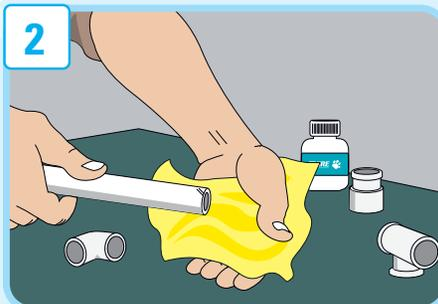
**2** Utilice la Solución Limpiadora para eliminar las impurezas que puedan impedir la posterior acción del adhesivo.
