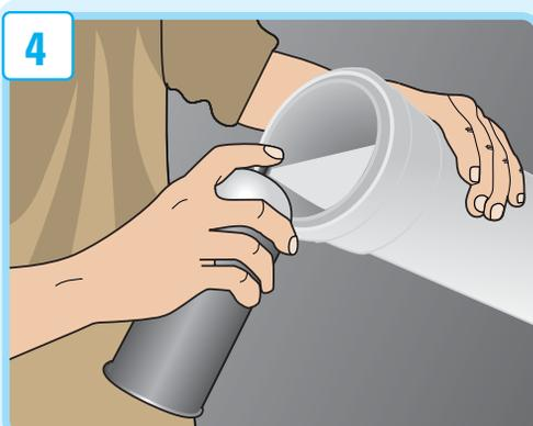
**Aplicación de solución lubricante:** Rociar el lubricante sobre la guarnición elastomérica de manera uniforme. Utilizar solamente la solución en aerosol, desarrollada a base de siliconas de primera calidad.
