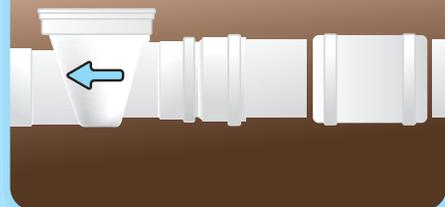
Corte un segmento de tubo más largo que la válvula antirretorno y utilice una cupla lisa o deslizante para realizar la instalación.
