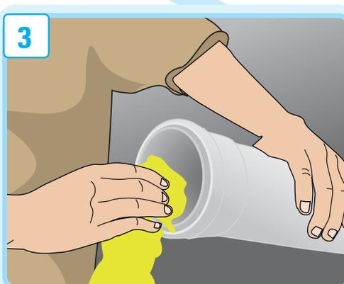
**Con trapo limpio se debe limpiar el enchufe** (o campana) y la espiga o extremo macho, removiendo todo vestigio de polvo o grasitud que obstaculice la libre penetración de la espiga dentro del enchufe, o bien, que pueda atacar la guarnición de doble labio y disminuir su expectativa de vida útil.
