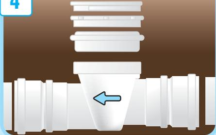
Para ajustar la profundidad de la válvula antirretorno en relación al piso, utilice un prolongador que puede ser hecho con un tubo de PVC de 150 mm.
