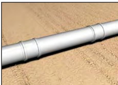
3- Se deslizarán las cuplas hasta cubrir las uniones entre el tubo nuevo y los extremos del original. Para facilitar el proceso, se deberá colocar Pasta Lubricante TIGRE.
