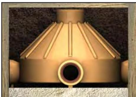
**e) Asentamiento del Til Radial Tigre:** el til radial debe ser nivelado y asentado sobre una fundación adecuada para prevenir deslizamientos. Si es necesario, el til deberá ser asentado sobre una cuna de arena o una base de hormigón.
