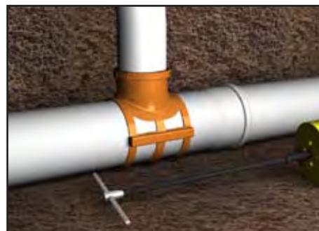
d) Complete la conexión utilizando conexiones VINILFORT, conforme con especificaciones.
