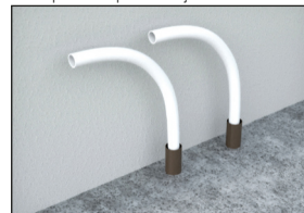
Tubos passando por uma laje
