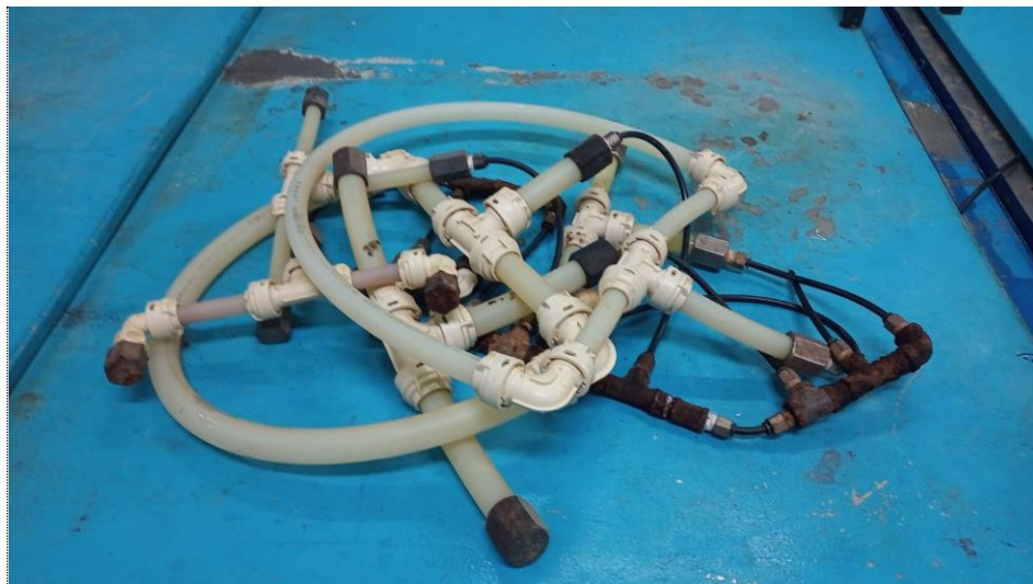
Figura 11 – Evidência - PHI de longa Duração 1000 horas 80°C / Estanqueidade
