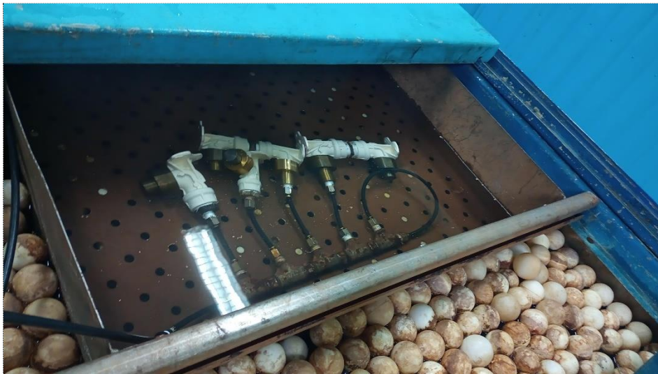
Figura 7 – Evidência - PHI de Curta Duração ( 1 hora ) 80°C
