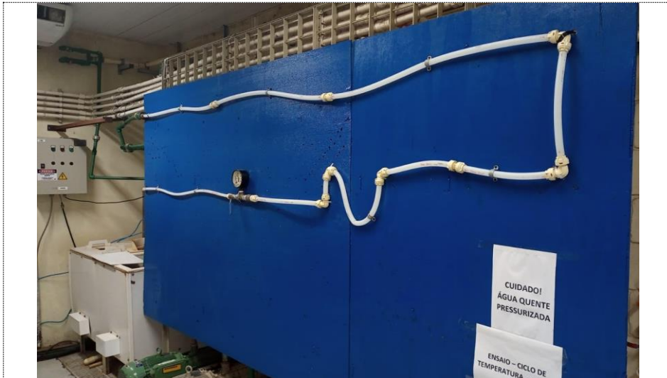
Figura 12 – Resistência ao Ciclo de Temperatura 5000 ciclos (15 x 15 min.)
