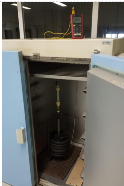
Figura 14 – Evidência - Resistência ao Esforço Axial ( 82 \pm 1 ) 1 hora
