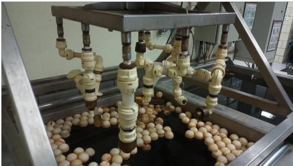
Figura 3 – Evidência - Ensaio de ciclo térmico (conexões com Inserto) 1000 ciclos
