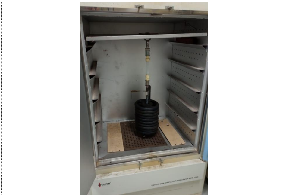
Figura 13 – Evidência - Resistência ao Esforço Axial ( 23 \pm 1 ) 1 hora
