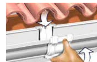
**5** Coloca las escuadras. Después de fijar la canaleta y las conexiones, encaje las escuadras en los puntos donde se proporcionan.
