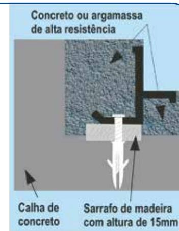
**3** Se puede hacer un refuerzo fijando la solapa horizontal del punto de referencia en el material de relleno con un tornillo adicional.
