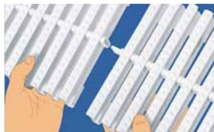
**Rejillas Rígidas:** que soportan mayor peso, no es necesario utilizarlas con las canaletas reforzadas, ya que la carga está soportada por el lastre de hormigón que rodea la canaleta.
