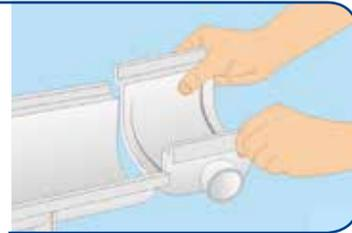
**3** Instale la canaleta con las rejillas ya colocadas para evitar que los perfiles se deformen al curar el concreto.
