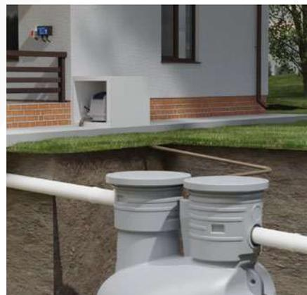
*Obs.: O soprador deve ser instalado em local abrigado de intempéries e com pelo menos duas fases abertas para circulação de ar.*
