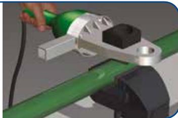
**4** Luego, caliente el sillín durante 20 segundos, pero sin quitar la boquilla de la tubería (calentamiento total de la tubería: 50 segundos).
