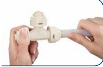
**Obs.:** Si la punta del tubo no está visible en el espía, significa que la junta ha sido mal ejecutada y pueden producirse fugas.poderão ocorrer vazamentos.
