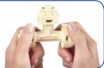
**4** Inserte el tubo en la conexión y, por medio del espía, asegúrese de que el tubo haya sido introducido hasta el extremo de la pieza. Durante el movimiento, asegúrese que el acoplamiento de las piezas sea de forma lineal, para evitar daños.
