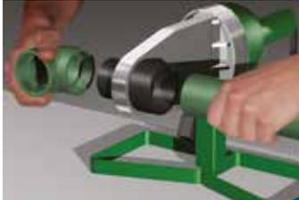
**6** Retire la tubería y la conexión del termofusor después de que haya pasado el tiempo mínimo determinado para la fusión, de acuerdo con la tabla 9.
