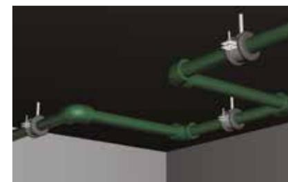
**B) Las liras de dilatación, formadas por 4 curvas a 90°, funcionan como un doble brazo deslizante. La longitud de la lira (LC) debe ser al menos 10 veces el diámetro de la tubería. La longitud del brazo deslizante (LB) se calcula mediante la fórmula anterior.**
