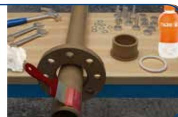
**3** Con un trozo de madera y un martillo, inserte la boquilla de la brida en el tubo hasta que llegue a su respaldo.
