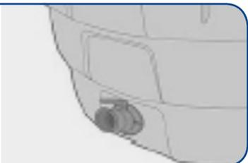
**5** Apriete a mano la brida libre desde el lado interior de la carcasa, hasta que la pieza se bloquee. No es necesario utilizar ningún otro material de sellado. La estanqueidad estará garantizada por la compresión del anillo de goma contra la pared del tanque de agua.
