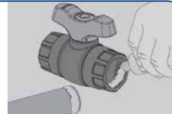
**2** Limpie las superficies lijadas con la Solución Preparadora TIGRE, eliminando impurezas y grasas. Distribuya uniformemente el adhesivo plástico con el pincel o la boquilla del propio tubo sobre las superficies tratadas.
