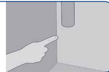
**Obs:** Instale la Válvula de Pie Tigre al menos 30 cm por encima de la parte inferior del depósito, esto evita la succión de impurezas o residuos.
