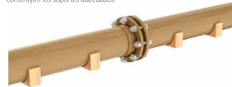
Los tipos de soporte pueden ser de hormigón, para líneas aparentes, y abrazaderas, para uso aéreo.
