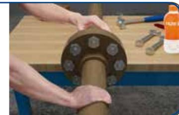
**6** El apriete de los tornillos debe ser gradual, tratando siempre de fijar el diametralmente opuesto al fijo.
