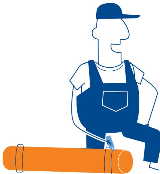
6. Insertar la espiga en la campana con un movimiento firme y parejo, la marca sobre la espiga indica la distancia a ser introducida, luego se procede a girarlo un cuarto de vuelta para distribuir mejor el Cemento Solvente.
