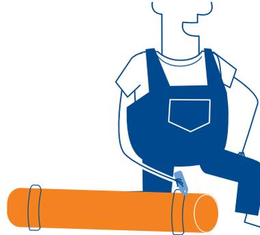
5. Aplicar el Cemento Solvente: se aplica con una brocha primero en la campana y solamente a un tercio de su longitud, y después al extremo biselado del otro tubo en una longitud equivalente al de la campana. La brocha debe estar siempre en buen estado, libre de residuos de Cemento Solvente seco para lo que se recomienda el uso del Limpiador. Esta brocha deberá ser la mitad del diámetro del tubo.
