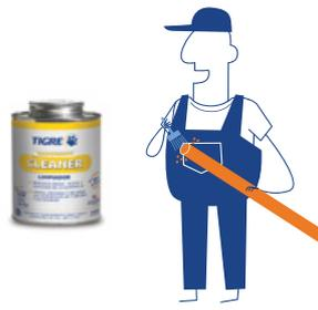
B. Limpiar las superficies lijadas con solución limpiadora TIGRE, eliminando las impurezas y grasa que podrían impedir la acción del adhesivo.
