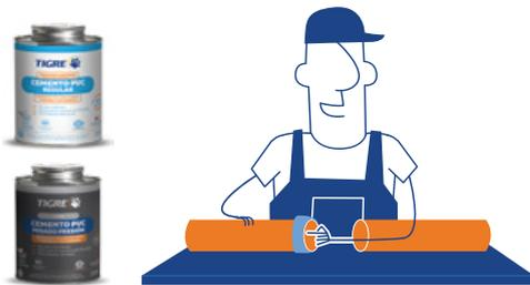
C. Continuar con la distribución uniforme del adhesivo en las superficies tratadas. Aplicar el adhesivo primero en la cabeza y, después en la punta del tubo.
