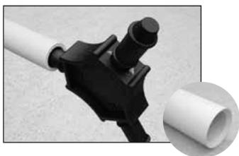
**Obs.:** O chanfro é obrigatório na instalação do sistema com Clicpex.
