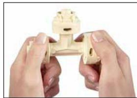
**Passo 4:** Insira o tubo na conexão e, por meio do espelho, certifique-se de que o tubo foi introduzido até o final da peça. Durante o movimento, garanta que o encaixe das partes esteja linear, para evitar avarias.
