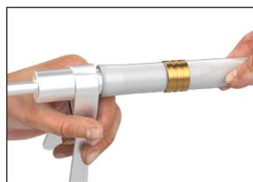
**Passo 3:** Insira a conexão na ponta do tubo. O tubo deve se encaixar até a última nervura da conexão, mantendo uma pequena distância de 2mm entre o tubo e a conexão.
