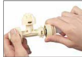
**Passo 3:** Separe a parte da conexão com a parte do tubo e o acoplador.
