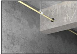
**Passo 4)** O sistema Aquatherm® pode ser aplicado normalmente, dentro de alvenaria convencional ou qualquer outro sistema não estrutural. É obrigatório o uso de isolantes térmicos para potencializar a reserva de água quente nas tubulações e assim garantir melhor eficiência energética, conforme NBR 5626:2020;
