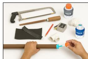
**Passo 4)** Encaixe imediatamente as extremidades a serem soldadas, o tubo deve ser inserido até o final da bolsa da conexão. Remova o excesso de Adesivo (cordão de solda) e espere 1 hora para encher a tubulação de água e 12 horas para fazer o teste de pressão ou liberar o abastecimento de água pressurizada.
