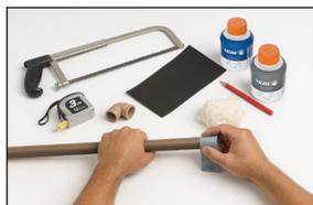
**Passo 2)** Limpe as superfícies de montagem da extremidade do tubo e da parte interna da bolsa da conexão com Solução Preparadora TIGRE, eliminando impurezas e gorduras.
