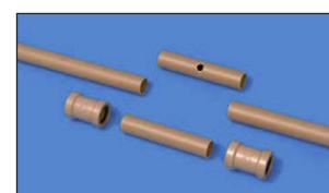
**C)** Realizar a montagem da Luva de Correr e novo segmento de tubo alinhado ao tubo existente, recomenda-se o uso de pasta lubrificante. A solução de problema com Luvas de Correr dispensa o uso de adesivo e roscas, pois as luvas possuem anéis de borracha para vedação.
