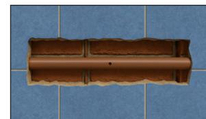
**B)** Retirar o segmento danificado de tubo, execute o corte no esquadro a direita e a esquerda do furo. O trecho danificado deve ser substituído por segmento do mesmo tipo de tubo. Chanfrar as extremidades dos tubos a serem montados. Use duas Luvas de Correr, uma em cada extremidade;
