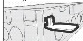
**Passo 5:** Termine a fixação parafusando a placa e os fixadores para Dry Wall. Utilize os rasgos existentes na borda do quadro como orientação de posicionamento dos fixadores. Caso preferir, parafuse os fixadores para Dry Wall direto no montante;
