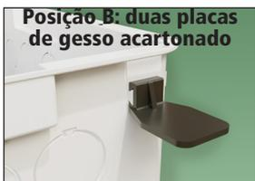
**Passo 5:** Termine a fixação parafusando a placa e os fixadores para Dry Wall. Utilize os rasgos existentes na borda do quadro como orientação de posicionamento dos fixadores. Caso preferir, parafuse os fixadores para Dry Wall direto no montante;
