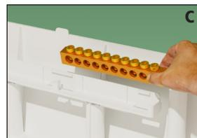
**Passo 6:** Faça a instalação elétrica conectando os fios NEUTRO e TERRA aos barramentos, e a fase e os disjuntores aos circuitos correspondentes. Para mais ligações, utilize mais barramentos conectando-os entre si com um jump.
