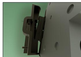
**Passo 5:** Fixe os barramentos NEUTRO e TERRA por simples encaixe nos alojamentos localizados nas bordas do quadro de embutir (A).
