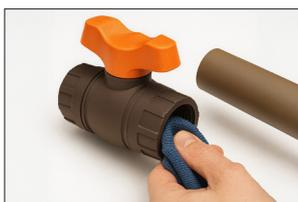
**Passo 2)** As pontas dos tubos e conexões já são fornecidas com um chanfro na extremidade para facilitar o encaixe. Caso seja necessário cortar o tubo, efetuar este corte no esquadro e em seguida chanfrar a extremidade ponta e retirar as rebarbas. Para a montagem seguir os procedimentos abaixo;
