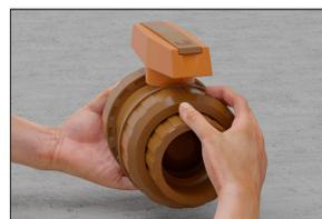
**Passo 2:** Remova a porca juntamente extremidade da bolsa.
