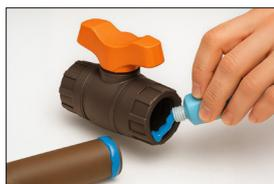
**Passo 7)** Alinhe a ponta do tubo com a bolsa do registro e encaixe de uma vez a extremidade a ser soldada, promovendo enquanto encaixar um leve movimento de rotação entre as peças de ¼ de volta até que a ponta do tubo seja inserida até o final da bolsa, observando a marcação inicialmente feita no passo 4 e limpar eventuais excesso de adesivo.
