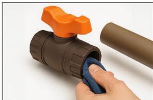
**Passo 6)** Para registros até 50mm: lixar a superfície externa na região delimitada no tubo e a interna da bolsa do registro com lixa d'água 100;
