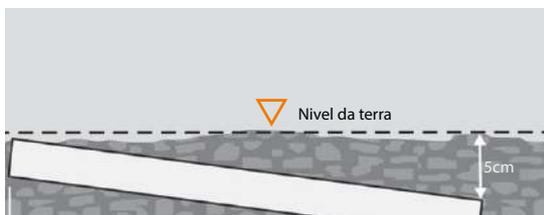
Figura 134 - Declividade em tubulação enterrada para drenagem
