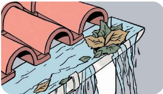
Ao realizar a limpeza, cuidado para não danificar as paredes da calha e suas vedações.
