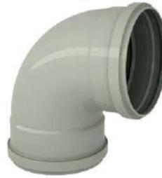
Essa conexão é fabricada com maior espessura de parede que as curvas tradicionais para resistir aos eventuais golpes dos sólidos que são escoados pelo tubo de queda. O ângulo de 87°30' deixa a tubulação horizontal com a declividade adequada. Avaliar a aplicação conforme a altura geométrica do tubo de queda. Corpos estranhos submetem a conexão de PVC a impactos aos quais ela não foi projetada.
