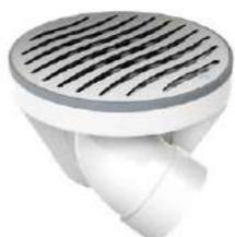
Pode ser aplicado em banheiros, lavabos, varandas, terraços, garagens, áreas de serviço, tanto de obras verticais quanto horizontais. Possui diâmetro interno do corpo compatível com o tubo de esgoto de 100 mm, utilizado como prolongador, e saída de 40 mm.
