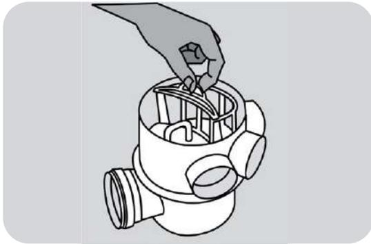
Figura 180 - Remoção da grelha da caixa sifonada girafácil
