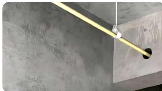
Figura 33 - Passagem por elementos estruturais
