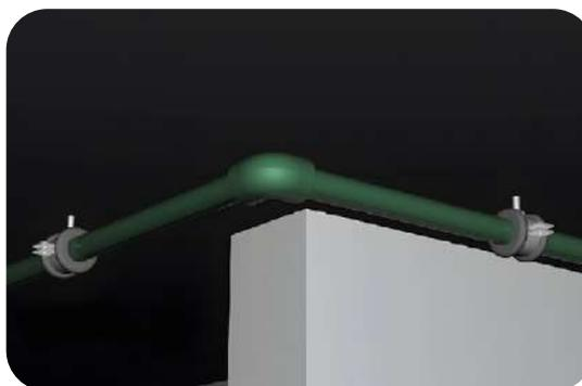
Figura 111 - Compensação de dilatação térmica com mudança de direção
