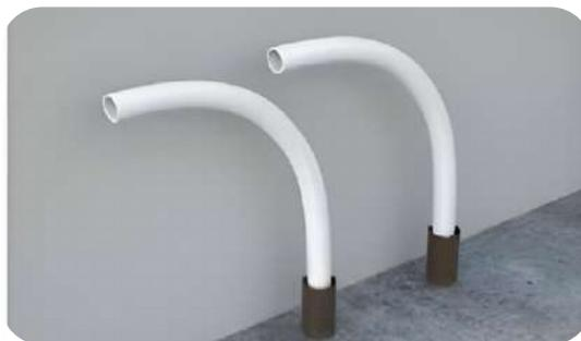
Figura 118 - Passagem de tubulações por vigas e lajes
