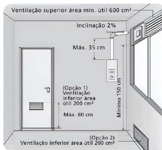
Figura 102 - Ventilação natural: áreas úteis e inclinação de dutos | Fonte: Adaptado de Adaptado de Carvalho Junior (2017)
