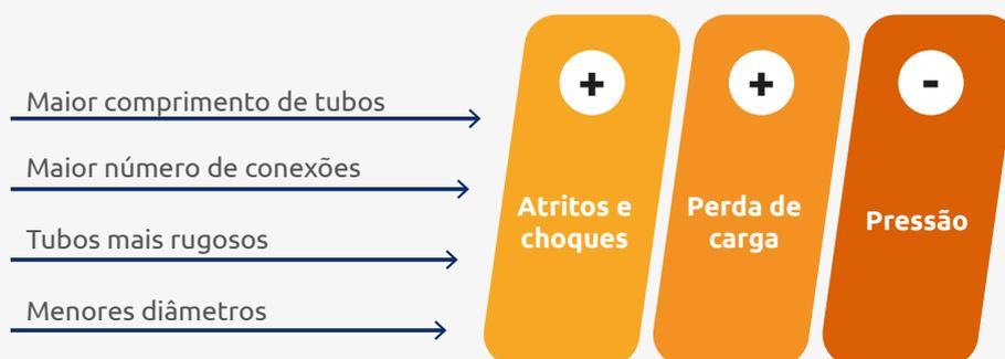
Figura 20 - Fatores que aumentam atritos e perda de carga em tubulações
