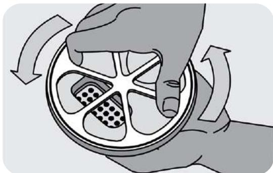
Figura 177 - Retirada da grelha
