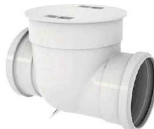
A Válvula de Retenção de Esgoto Tigre foi projetada para evitar retorno nas instalações prediais de esgoto e águas pluviais, principalmente nos casos de inundações, enchentes, refluxo das marés, entupimentos, ou ainda de vazões elevadas nos períodos de fortes chuvas. Ela possui um anel de borracha para vedação da tampa, o que impede a liberação de mau cheiro e pode trabalhar a uma temperatura de 45°C em regime não contínuo.
