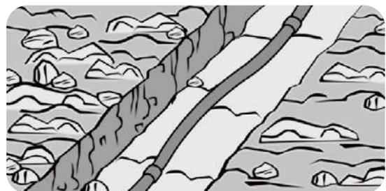
Figura 84 - Instalação de tubulação enterrada em formato de cobra
