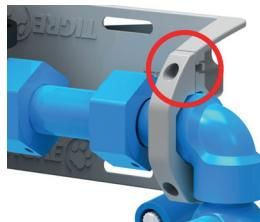
**7.** Fixar o conjunto no Suporte de Fixação (peça **F**), utilizando as Abraçadeiras de fixação (peça **G**), observando o perfeito encaixe das saliências dos componentes (B e D) nos rasgos das Abraçadeiras de Fixação.
