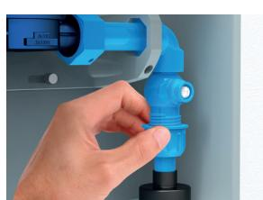
**10.** Conectar o tubo de PEAD Ø 20 mm no conjunto, desrosqueando a porca do registro de entrada (peça A), e inserir o tubo PEAD no seu interior, rosqueando novamente a porca manualmente.
