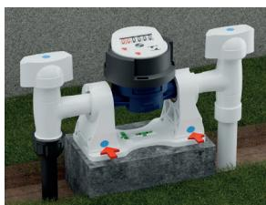
**Passo 10:** Após a colocação dos pinos, abra o registro de entrada lentamente para que a água flua pelo hidrômetro e verifique se o conjunto apresenta algum vazamento, corrigindo-o se necessário. Em seguida insira os lacres botões certificando-se do travamento com os pinos após ouvir o clique de encaixe.
