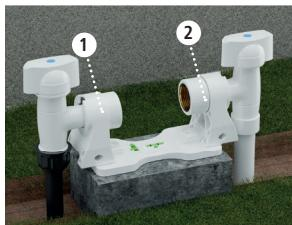
**Passo 6a:** Encaixe o conjunto coluna deslizante e registro com válvula de retenção (1) no trilho correspondente a entrada do ramal predial. Faça o mesmo procedimento com o conjunto coluna deslizante com dispositivo de aferição (2).
