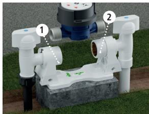
**Passo 8:** Instale o hidrômetro na UMC através das porcas 1 e 2, conforme ilustração. O aperto das porcas deve ser manual.
