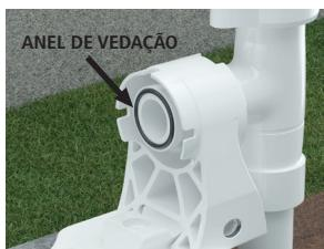
**Passo 7:** Antes da instalação do hidrômetro insira os anéis de vedação nas canaletas. Veja a posição final conforme ilustração.
