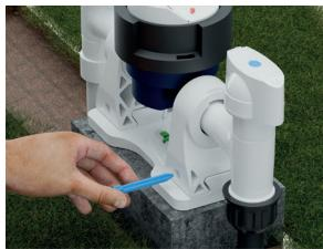
**Passo 9:** Coloque os dois pinos pela parte traseira da UMC para impedir o deslocamento das colunas deslizantes com a base.
